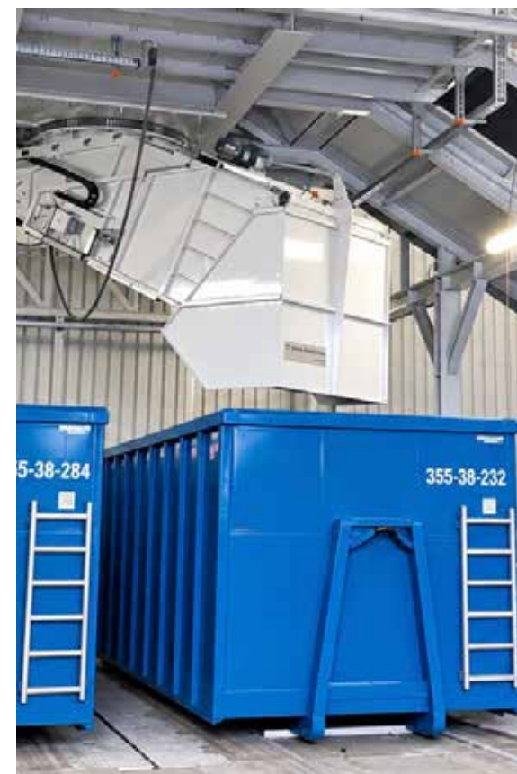
Wertvolle Lösung: Eine Magnettrommel in der Schrottentsorgung.
